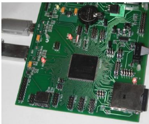
Figura 3. Imagen de la placa de desarrollo con una tarjeta SD y pen drives conectados.
