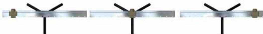
Figura 1 Esquema, en vista superior, con la posición de la cámara para la generación de tripletas.
