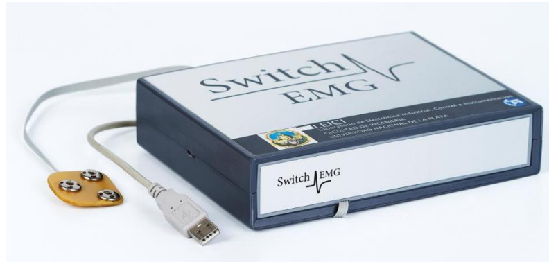
Figura 4: Fotografía del dispositivo construido donde se observa la placa que contiene los electrodos y la conexión USB.
