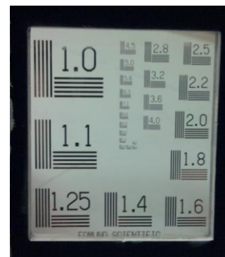
Figura 4. Tarjeta de resolución por transmisión Edmund Optics NBS 1963A utilizada
