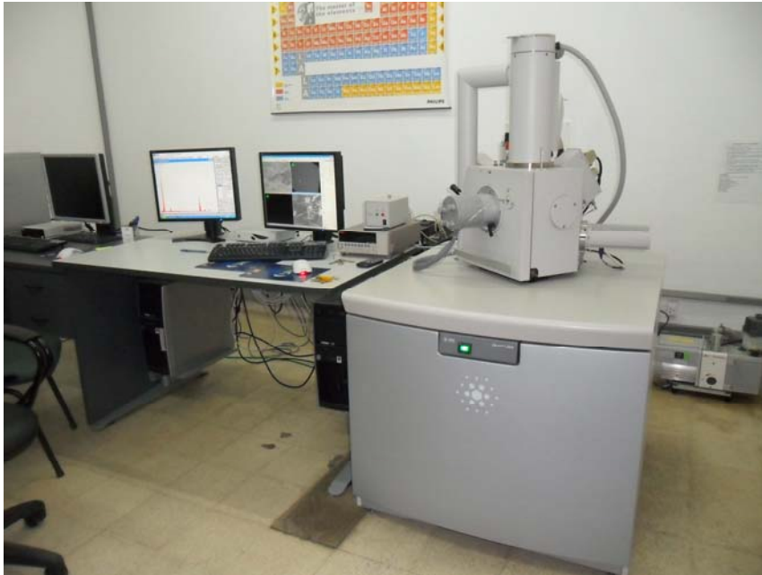
Figura 1. Microscopio Electrónico de Barrido Ambiental, FEI Quanta 200 del LIMF.
