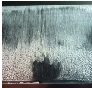
Figura 6. (a) borde de fuga (b) borde de ataque V = 11 \text{ m/s} ; \alpha = 10^\circ a 19^\circ (dinámico)
