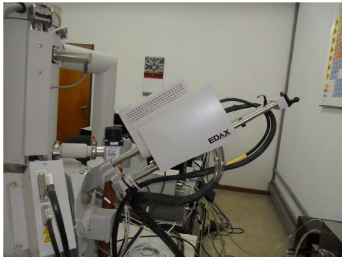
Figura 4. Espectrómetro de rayos X dispersivo en energías EDAX SDD Apollo 40.
