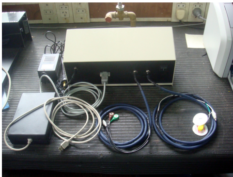
Figura 4. Autoglossómetro con periféricos conectados
