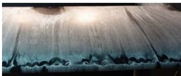
Figura 5. (a) borde de fuga (b) borde de ataque V = 11 \text{ m/s} ; \alpha = 13^\circ (estático)
