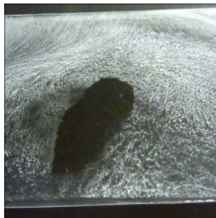
Figura 7. (a) borde de fuga (b) borde de ataque V = 11 \text{ m/s} ; \alpha = 19^\circ (estático)
