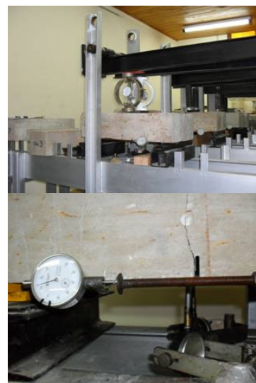
Figura 3. Disposición de las vigas durante el desarrollo de los ensayos de fluencia en estado fisurado.
