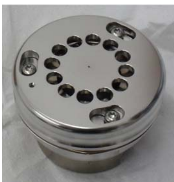
Figura 3. Imagen del cilindro de Wehnelt utilizado en el ESEM del LIMF.
