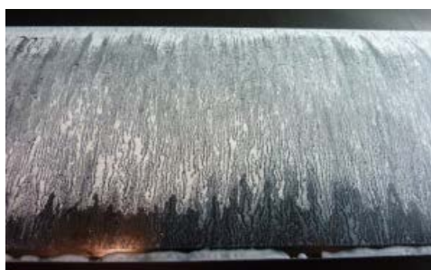
Figura 4. (a) borde de fuga (b) borde de ataque V = 11 \text{ m/s} ; \alpha = 8^\circ (estático)
