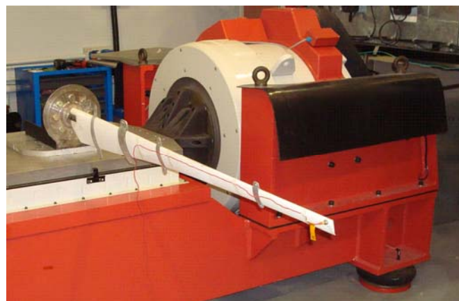
Figura 2: Pala en vibrador, con acelerómetro.
