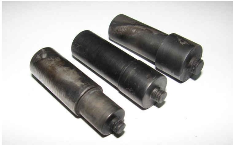
Figura 3: Fotografía de las herramientas de soldadura luego del tratamiento térmico de temple y revenido.
