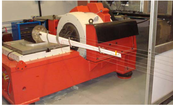
Figura 3: Pala en vibrador, con acelerómetro y tensores de carga en tres estaciones.
