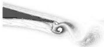
Figura 2. Esquema de las estructuras vorticosas contrarrotativas.
