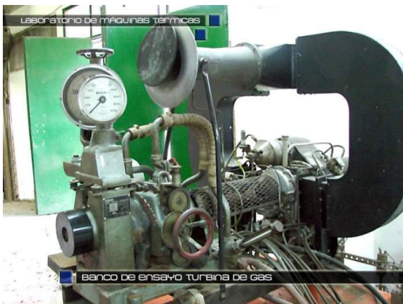
Figura 5.2.1. Fotografía del banco de ensayo de turbina de gas Rover y tablero de comandos, en su nueva ubicación dentro de la sala acondicionada a tal efecto.
