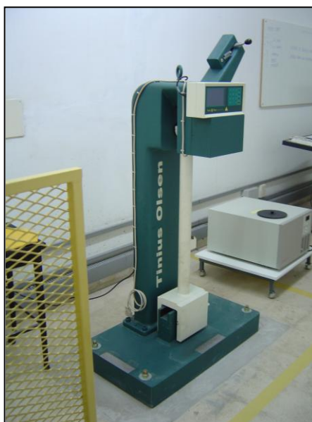
Figura 5.2.11. Equipamiento para la realización de ensayos de impacto a distintas temperaturas.
