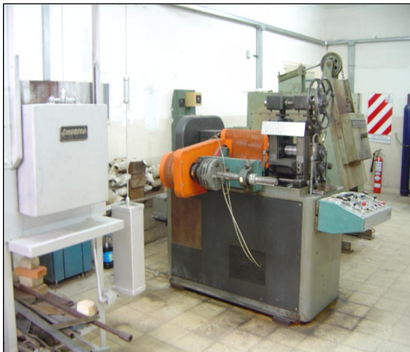
Figura 5.2.15. Laminadora y hornos de calentamiento. Izquierda horno calefaccionado con resistencias de Khantall, derecha, horno calefaccionado con varillas de carburo de silicio.
