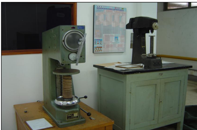
Figura 5.2.12. Equipos para la realización de ensayos de dureza. A la izquierda máquina universal de ensayos de dureza, a la derecha durómetro Rockwell.
