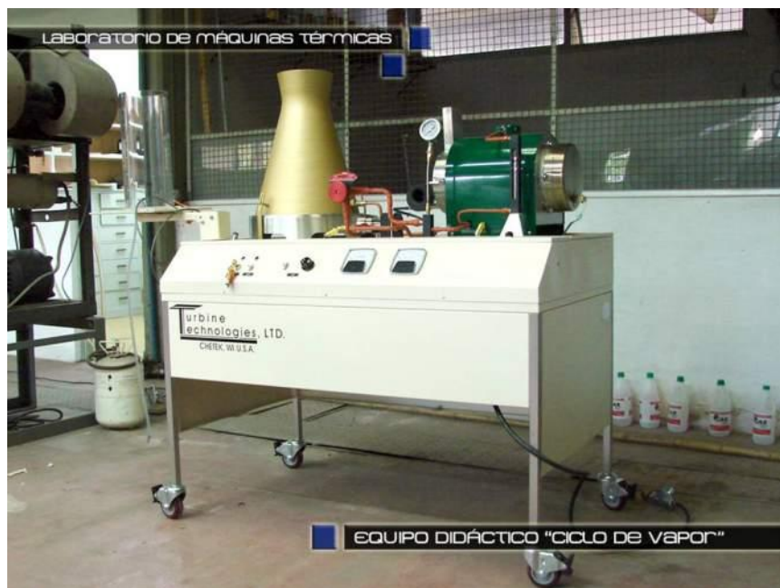
Figura 5.2.4. Planta Piloto de Vapor.
