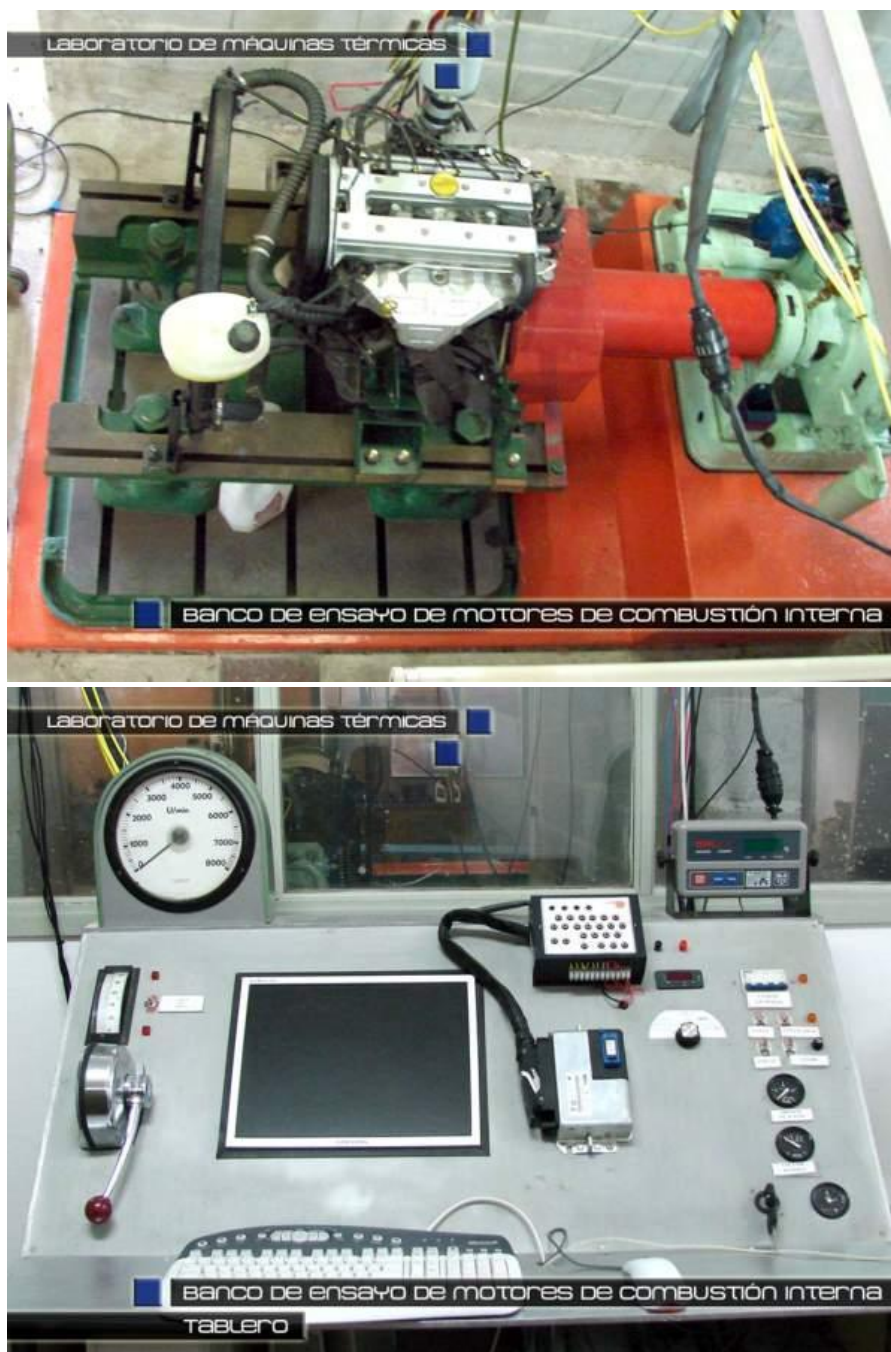
Figura 5.2.2. Fotografías del banco de ensayo de motores de combustión interna donde puede apreciar el motor Vectra instalado, y el tablero de comando dispuesto en la sala acondicionada a tal fin.
