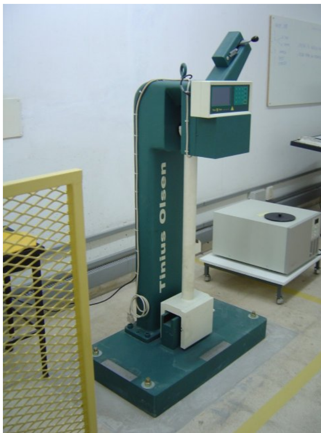
Figura 5.2.7 – Péndulo para ensayos de impacto y cámara ambiental
