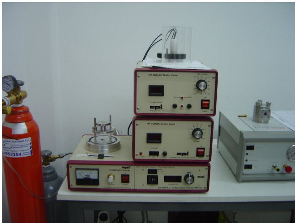
Figura 5.2.3 – Equipo de metalización de muestras
