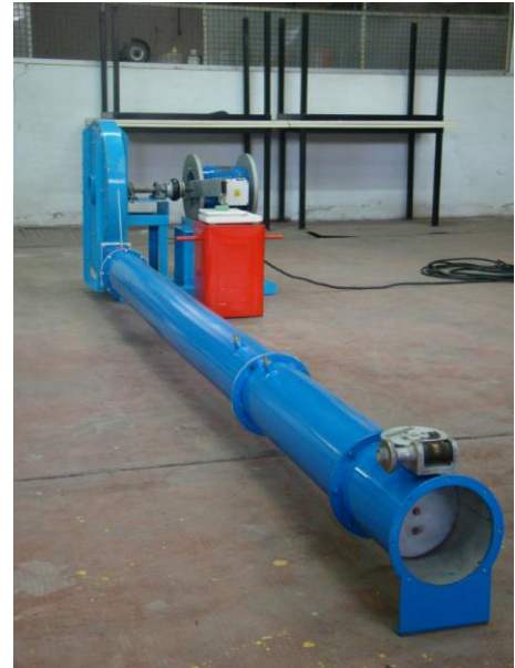
Figura 5.2.8. Dispositivo para la verificación del primer principio de la termodinámica.
