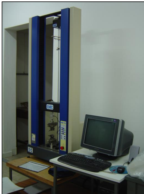
Figura 5.2.10. Fotografía del equipo para la realización de ensayos de tracción.
