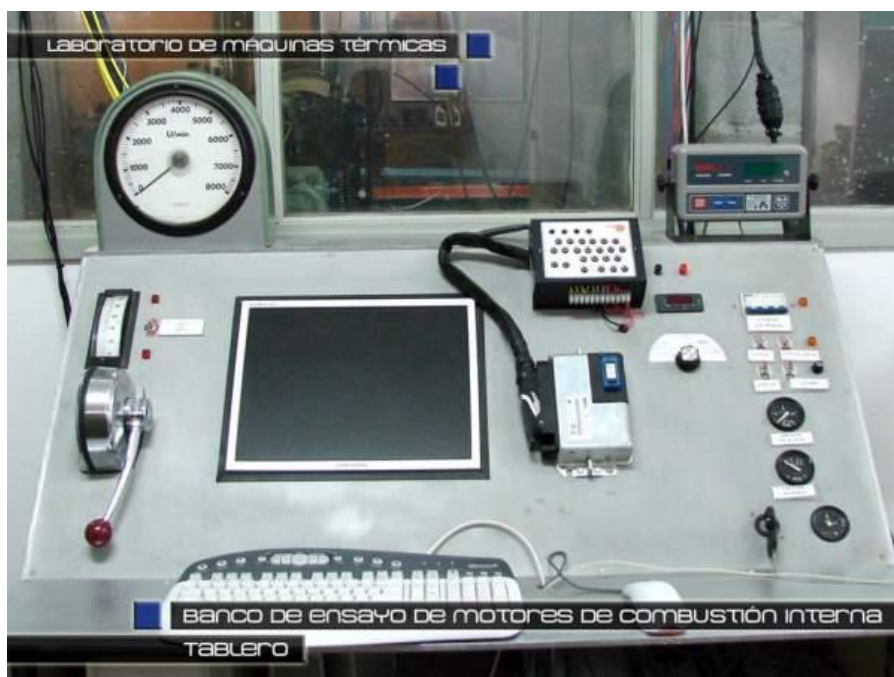
Figura 5.2.2. Fotografías del banco de ensayo de motores de combustión interna donde puede apreciar el motor Vectra instalado, y el tablero de comando dispuesto en la sala acondicionada a tal fin.
