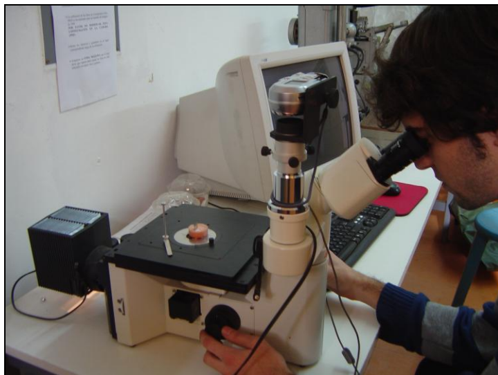
Figura 5.2.13. Banco Metalográfico Marca Leica con sistema de adquisición y análisis de imágenes.
