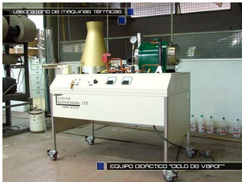
Figura 5.2.4 Planta Piloto de Vapor.
