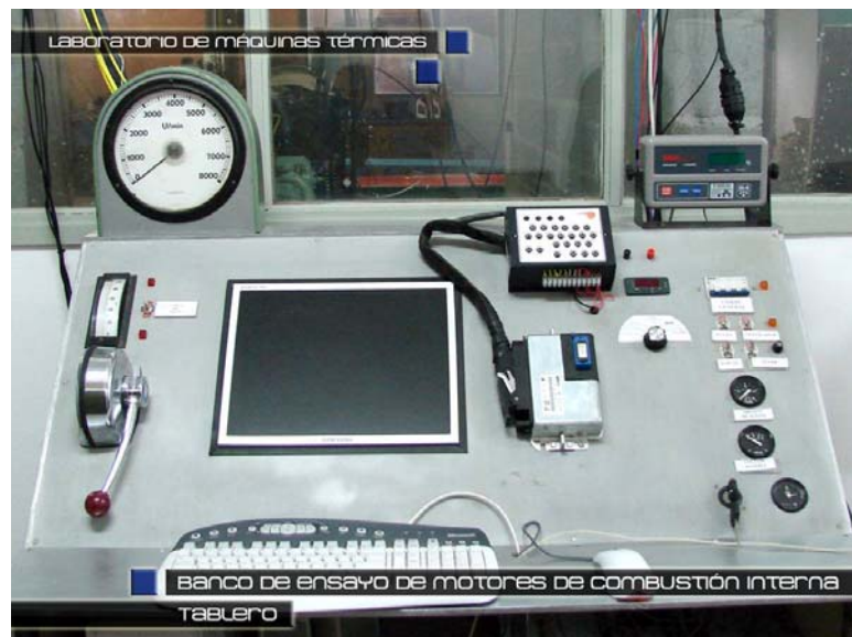
Figura 15: Fotografías del banco de ensayo de motores de combustión interna donde puede apreciarse el motor Vectra instalado, y el tablero de comando dispuesto en la sala acondicionada
