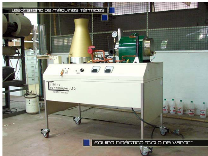
Figura 17: Planta Piloto de Vapor
