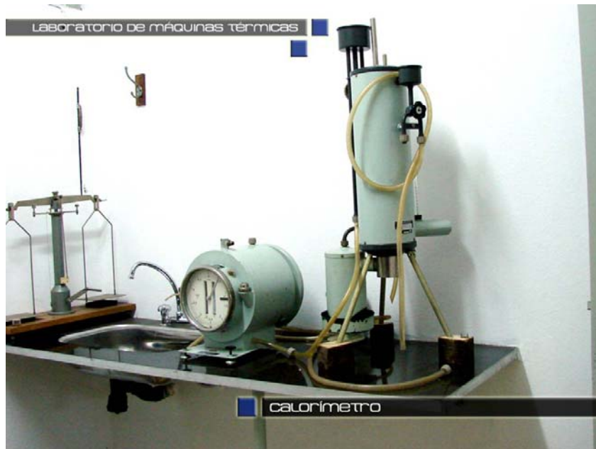
Figura 16: Disposición del calorímetro Junker en la nueva sala.
