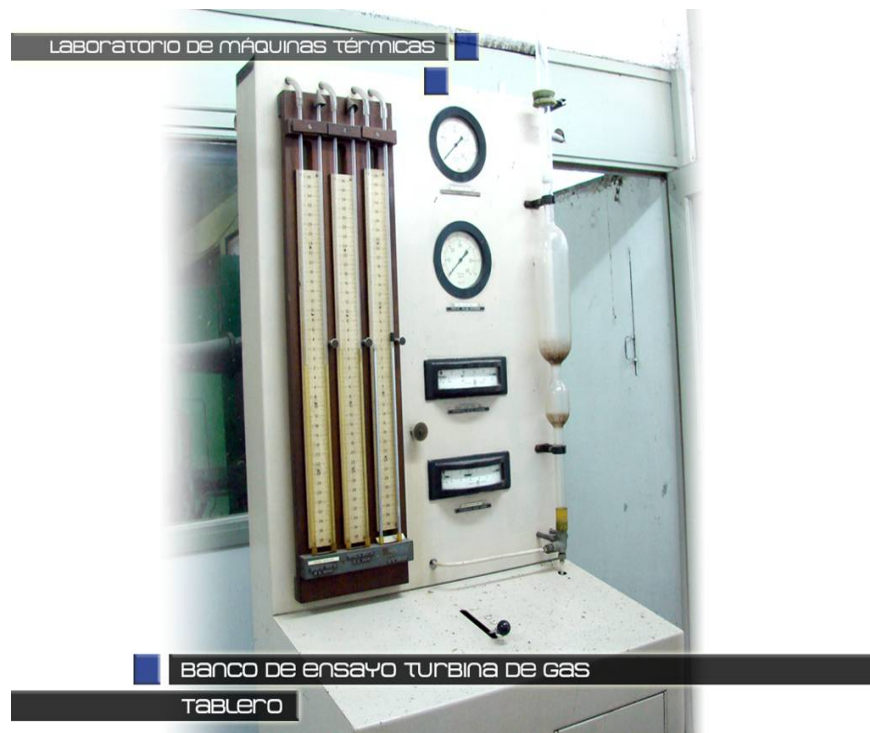
Figura 14: Fotografía del banco de ensayo de turbina de gas Rover y tablero de comandos, en su nueva ubicación dentro de la sala acondicionada a tal efecto.
