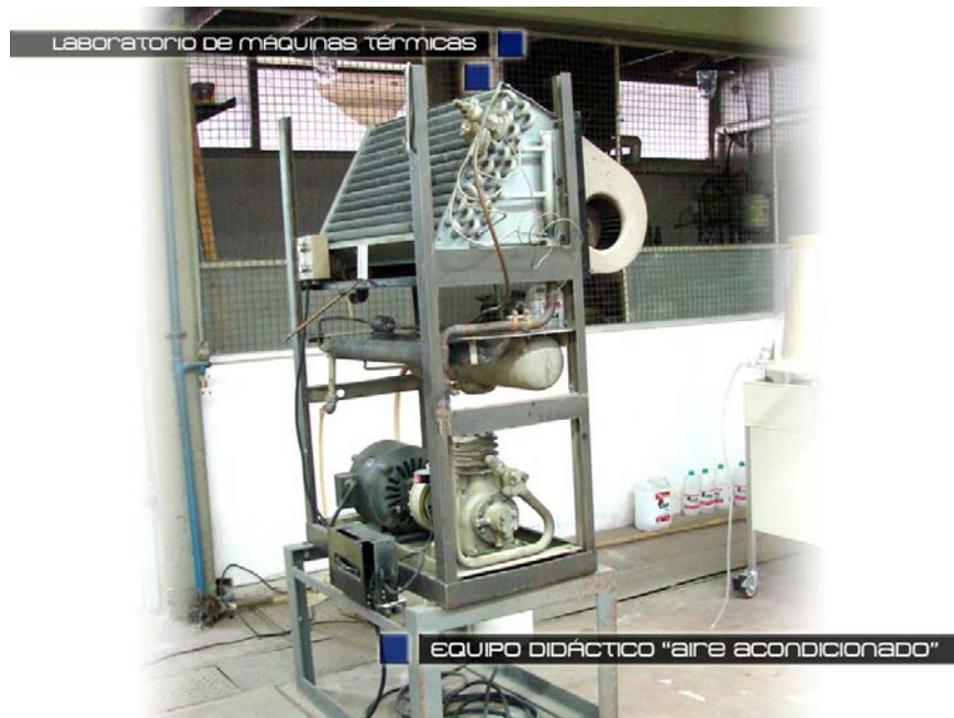
Figura 20: Fotografías del equipo didáctico de aire acondicionado.
